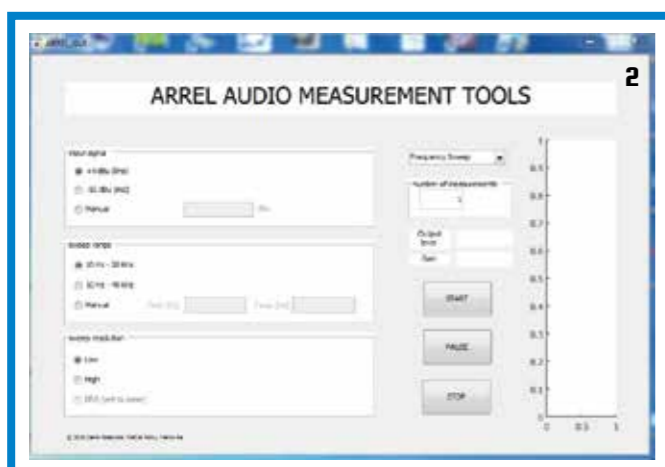
2_ Esempio di GUI nel caso di misura della risposta in frequenza.
