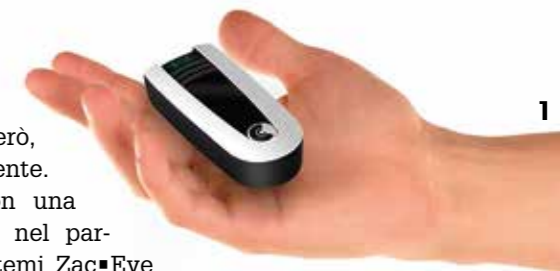
1_ Uno dei quattro "tag" che ritrasmettono il laser codificato per identificare un specifico soggetto da seguire.
