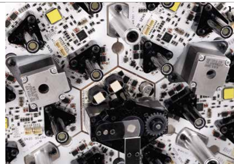
1_ Il circuito stampato dietro l'assemblaggio delle lenti con, al centro, il meccanismo del "effetto flower". I collimatori delle varie sorgenti sono negli involucri neri rialzati.
