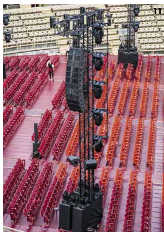
11_ Una delle 12 torri audio/luci, questa con un singolo array di 12 KARA per le gradinate, 2 112p downfill, 4 Vari*Lite VL4000 Spot, 1 VL4000 BeamWash e 6 SGM Q7.
