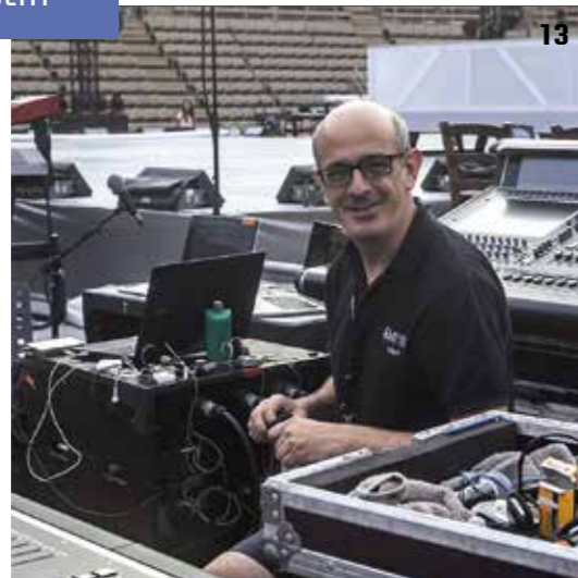
14_ Nella regia di palco, il rack dei sistemi radio – radiomicrofoni Shure Axient, e radiomicrofoni ed IEM Sennheiser 2000.
