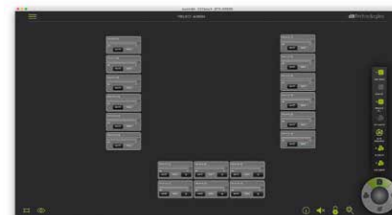
La finestra principale, con la vista complessiva degli item inseriti nel software. Su ciascun item sono disponibili i principali parametri di monitoraggio e controllo, completamente configurabili.
