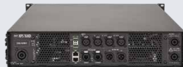
Il retro di XPS 16KD. Due delle porte di rete sono dedicate alla rete audio Dante, ma garantiscono in ogni caso il passaggio dei segnali RDNNet per il monitoring e il controllo remoto.
