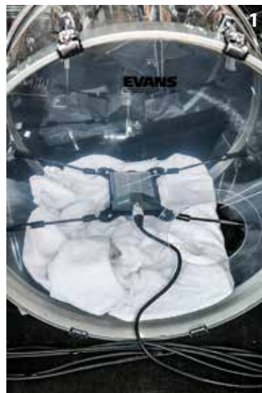
1_ Soluzione "galleggiante" del microfono sulla cassa. 2_ Uno dei microfoni CRD 1 della ditta romana MELLab, usati in diverse posizioni per la ripresa della batteria.
