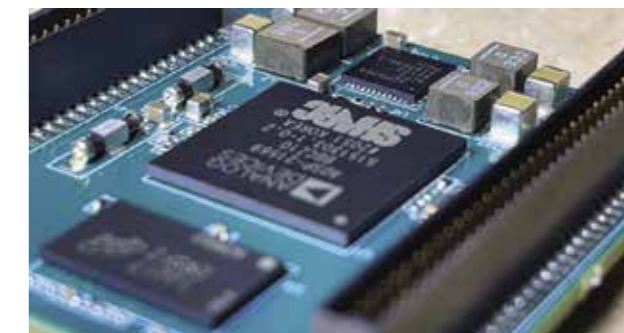
Un dettaglio della scheda di processamento DSP basata su SHARC.
