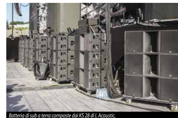
Batteria di sub a terra composte dai KS 28 di L-Acoustics.
