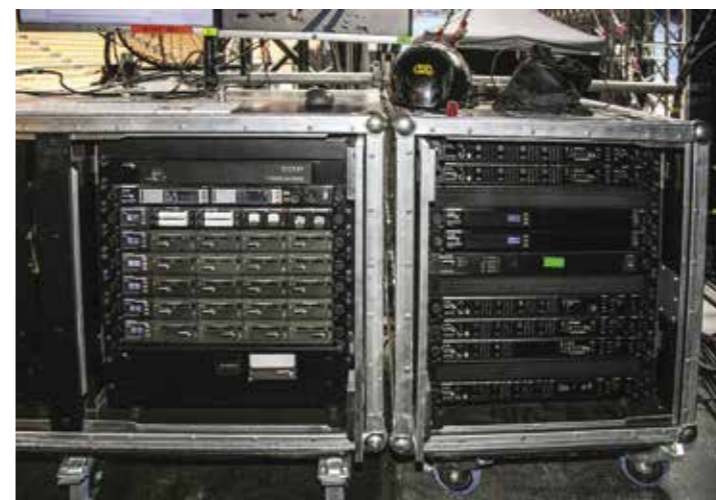
I due rack di ricevitori e trasmettitori dei vari microfoni e In-Ear Monitor.
