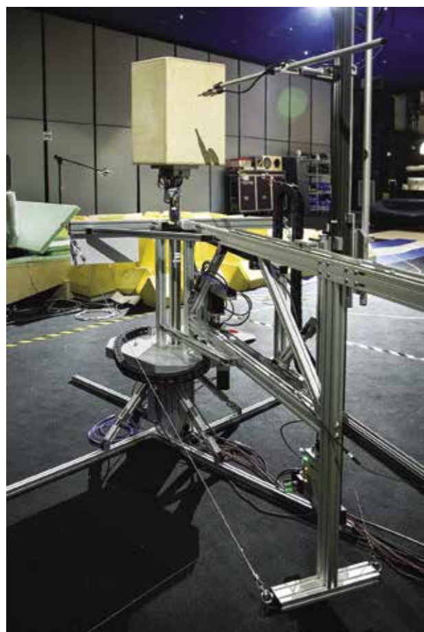
Il sistema di acquisizione acustica Near Field Scanner dedicato alla misura di direttività dei sistemi di altoparlanti.
