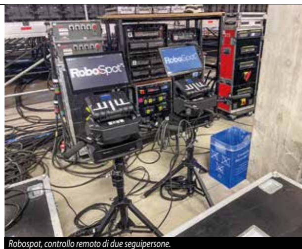
Robospot, controllo remoto di due seguipersona.
