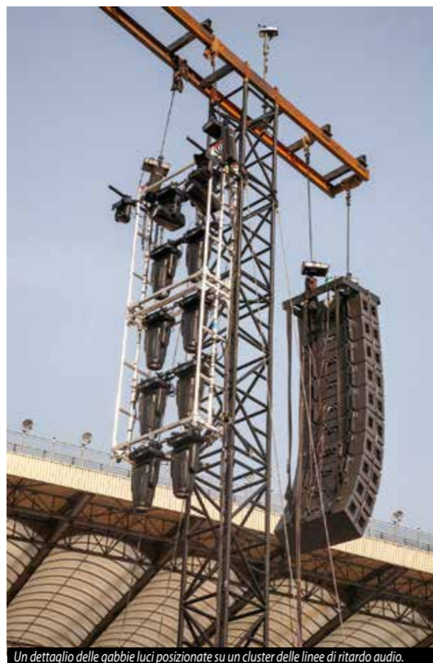
Un dettaglio delle gabbie luci posizionate su un cluster delle linee di ritardo audio.
