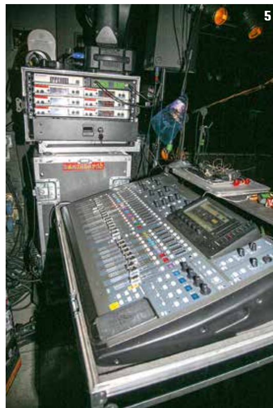
5_ La regia monitor, con una Behringer X32 e trasmettitori Sennheiser ew300G3.
