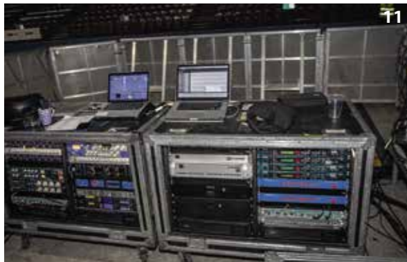
11_ I rack di outboard nella regia di sala.
