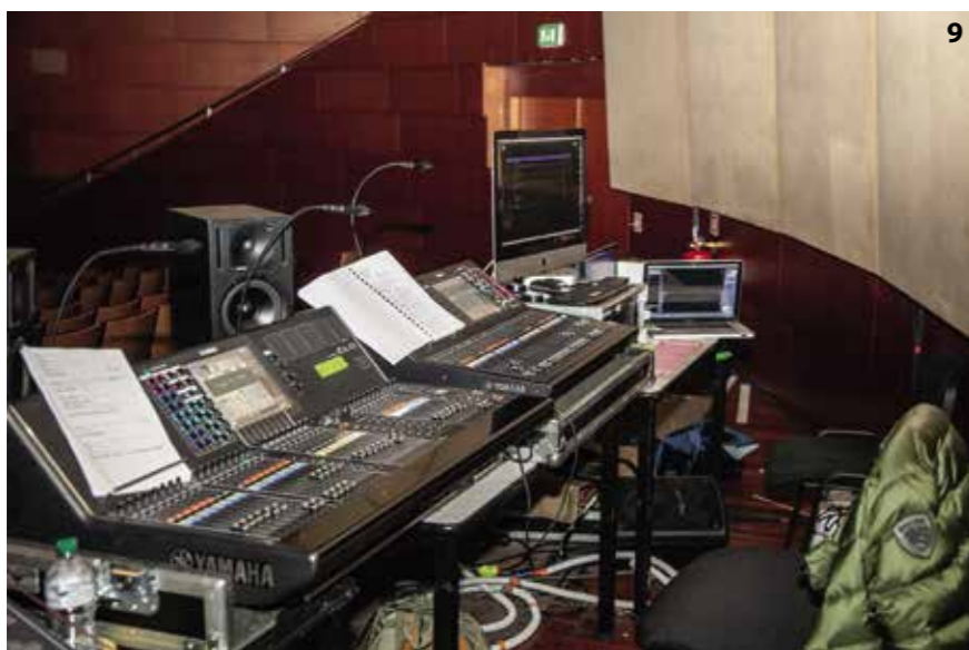
9_ La regia audio FoH con la console Yamaha CL5 per il mixaggio dello show e la console Yamaha QL5 per il controllo rapido e premix dei vari microfoni degli attori.
